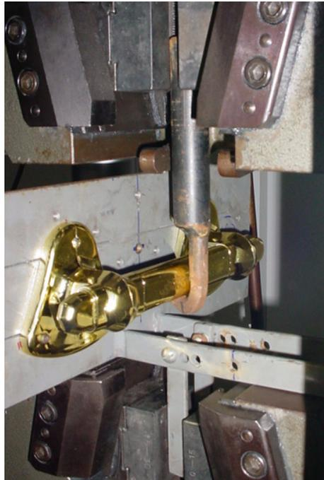
**Foto 1 .** Conjunto (dispositivo x amostra) montado na máquina de tração para a realização do ensaio.
