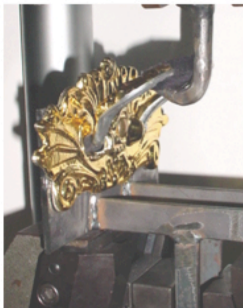
Foto 1. Conjunto montado na máquina de tração para a realização do ensaio.
