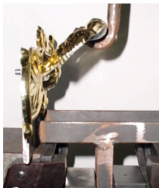
Foto 1. Conjunto montado na máquina de tração para a realização do ensaio.
