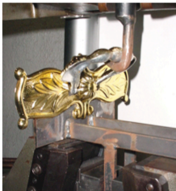
Foto 1. Conjunto montado na máquina de tração para a realização do ensaio.
