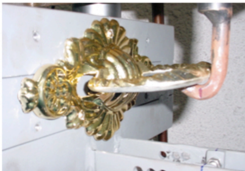
Foto 1. Conjunto montado na máquina de tração para a realização do ensaio.
