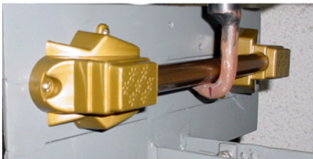
Foto 1. Conjunto montado na máquina de tração para a realização do ensaio.
